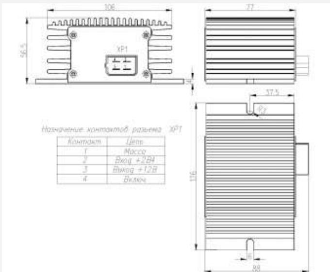
Преобразователь напряжения автомобильный предназначен для преобразования напряжения бортовой сети грузового автомобиля или автобуса 24В в постоянное напряжение 12В для питания различных устройств:
