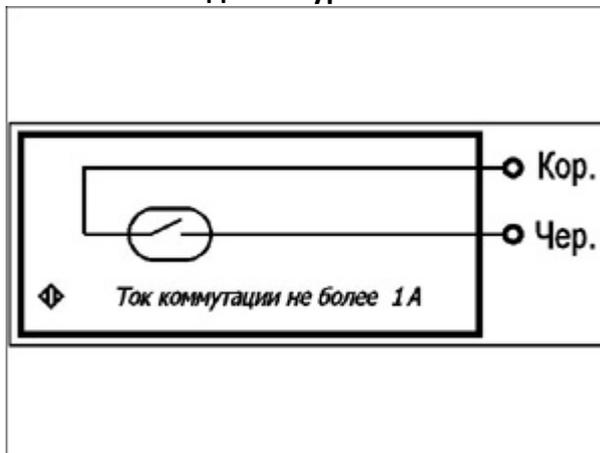
Схема подключения поплавкового датчика уровня ВБУ 1.68
