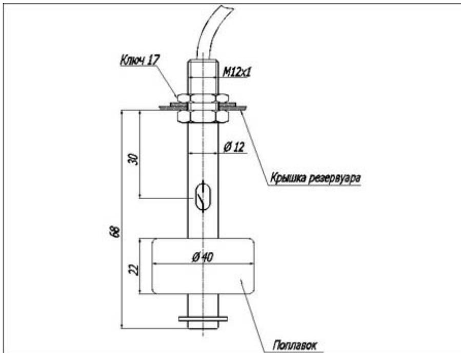
Поплавковый датчик уровня ВБУ 1.68
